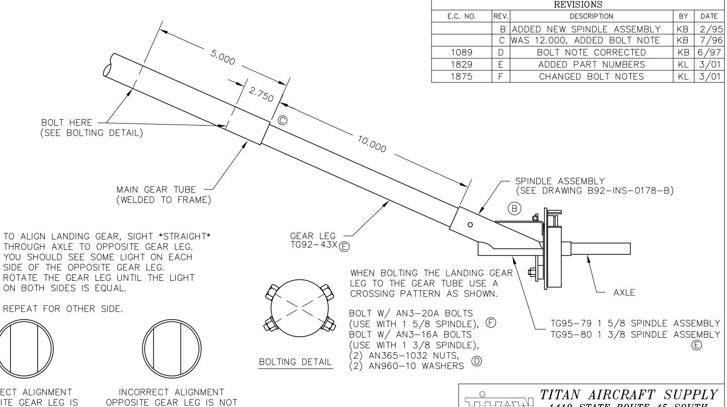
CORRECT ALIGNMENT OPPOSITE GEAR LEG IS CENTERED (LIGHT EQUAL)
